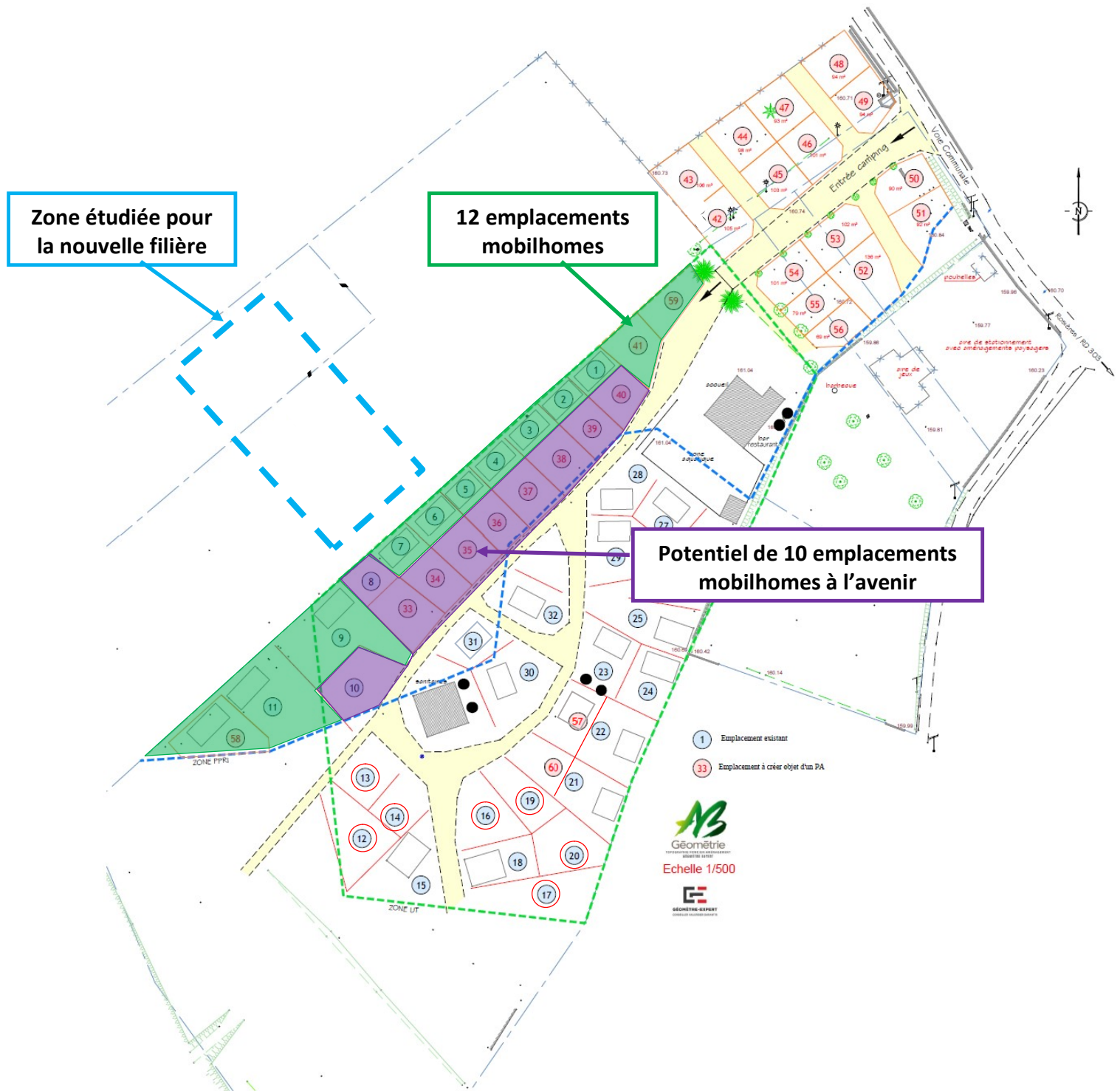
FIGURE 8 : LOCALISATION DE LA ZONE D'ÉTUDE POUR LA NOUVELLE FILIÈRE D'ASSAINISSEMENT AUTONOME ET DES EMPLACEMENTS À RACCORDER / CAMPING ACACIAS SUR PLAN AB GEOMETRIE (MODIFIÉ PAR NOS SOINS)
