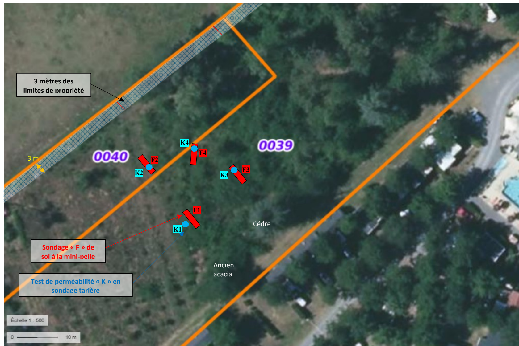
FIGURE 10 : LOCALISATION DES SONDAGES « F » ET DES TESTS DE PERMEABILITE « K » (EXTRAIT DE GEOPORTAIL)
