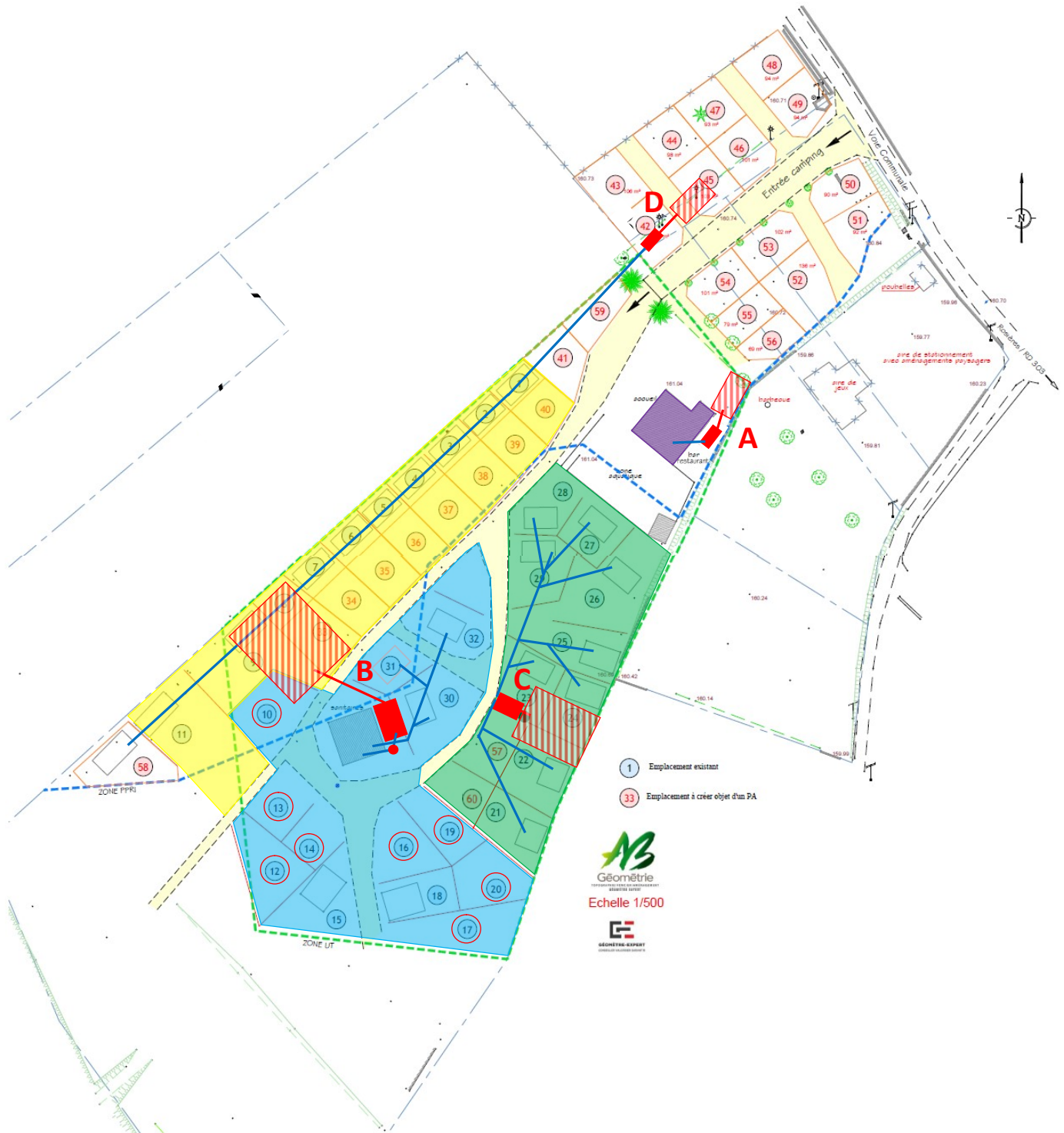
FIGURE 6 : LOCALISATION DES FILIERES EXISTANTES A, B, C ET D D'ASSAINISSEMENT AUTONOME SUR LE CAMPING ACACIAS ET SCHEMA DE PRINCIPE DES EMPLACEMENTS RACCORDES (FOND : PLAN AB GEOMETRIE MODIFIE PAR NOS SOINS)
