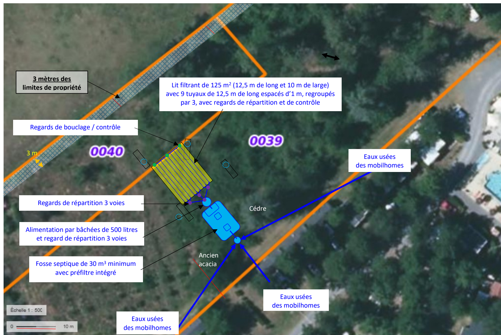
FIGURE 12 : SCHEMA DE PRINCIPE DU PROJET DE NOUVELLE FILIERE D'ASSAINISSEMENT (EXTRAIT DE GEOPORTAIL)
